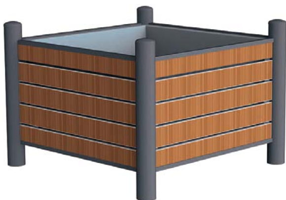
JA 305 LAH – 275 L DIM. 1000 X 1000 HT 740 PIEDS ROUNDS Ø76 TÊTES BOMBÉES HABILLAGE EN LAMES DE COMPACT HORIZONTALES CONTENANT EN POLYPROPYLÈNE RECYCLÉ
