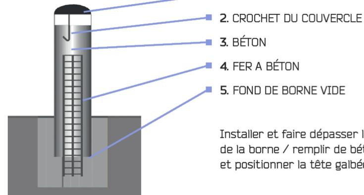
Installer et faire dépasser le fer à béton\*\* de la borne / remplir de béton\*\* et positionner la tête galbée
