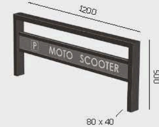
AM 40 PM 40 À SCELLER AVEC OPTION PLAQUE MÉTAL SIGNALÉTIQUE ENTRE TUBE 30 X 30
